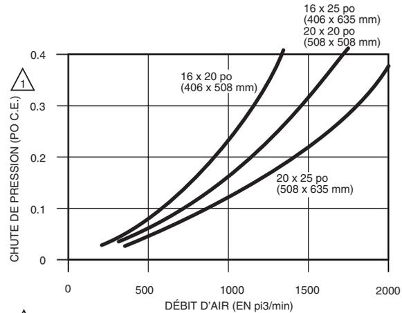
1 LORS DE LA PREMIÈRE INSTALLATION. LA CHUTE DE PRESSION AUGMENTE À MESURE QUE LE FILTRE SE REMPLISSE. REMPLACER LE FILTRE LORSQUE LA CHUTE DE PRESSION ATTEINT 0,5 PO C.E. (0,1 kPa).
