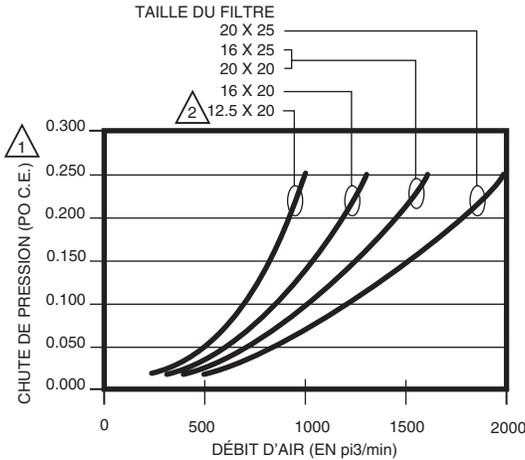
1 LORS DE LA PREMIÈRE INSTALLATION. LA CHUTE DE PRESSION AUGMENTE À MESURE QUE LE FILTRE SE REMPLISSE. REMPLACER LE FILTRE LORSQUE LA CHUTE DE PRESSION ATTEINT 0,5 PO C.E. (0,1 kPa).
