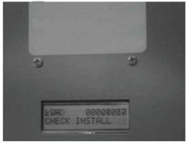
Fig. 18. Check Install Error.
